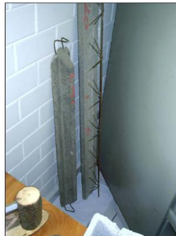
Viga de Laje
